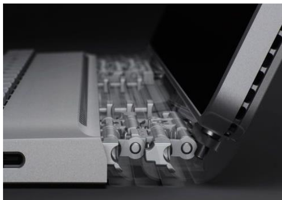
图表49： 微软 Surface Book 采用“动态支点铰链”设计
