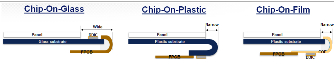
图表 53：COG、COP、COF 封装工艺对比
