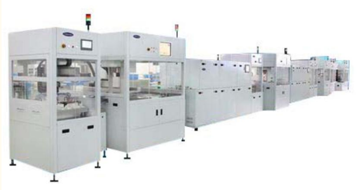
图表 3：太阳能电池丝网印刷生产线成套设备（整线）
