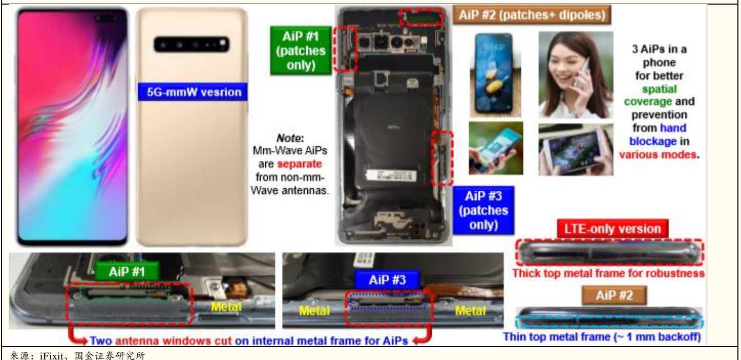
图表 27: 三星 5G 毫米波机型 Aip 模组采用 MPI 连接
