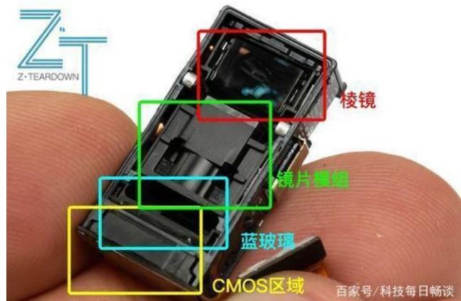
图 28：OPPO 潜望式摄像头拆解
