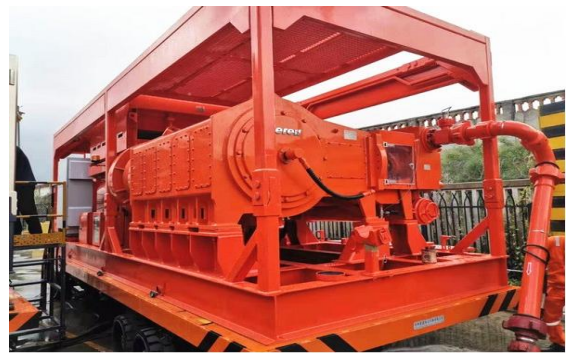
图 6：杰瑞自主研发制造的 7000 型电驱压裂橇成功下线
