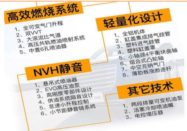
图 39：GW4B15 发动机技术特点
