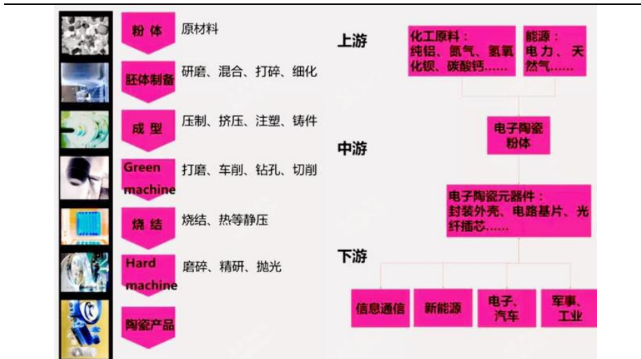
图表 5：先进电子陶瓷产品的加工工艺流程
