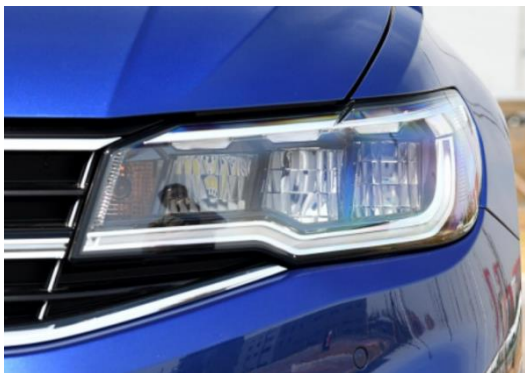
图21：新宝来反射式 LED 大灯
