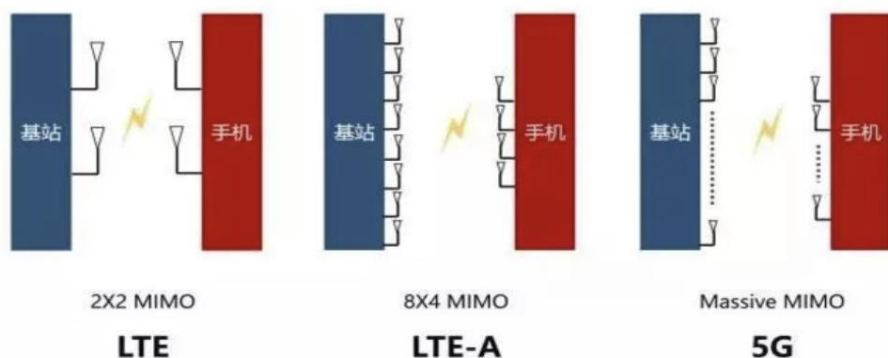
图 77：5G 时代采用 Massive MIMO 技术
