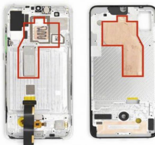
图 102：智能手机超薄 VC 示意图
