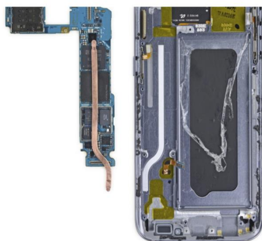
图 101：智能手机超薄热管示意图
