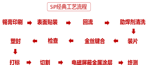
图 91: SiP 工艺流程
