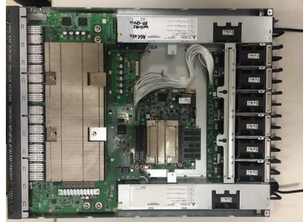
图表2：Delta 32*400Gbe 交换机内部硬件
