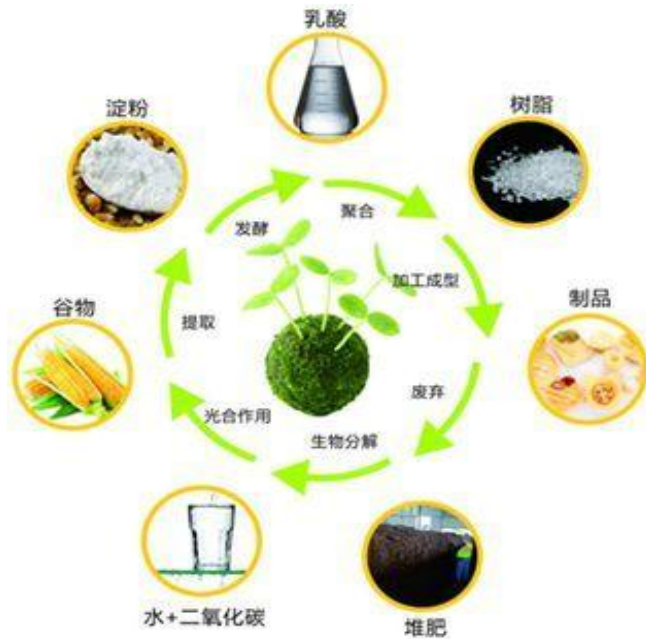
图 65: 聚乳酸生态循环示意图
