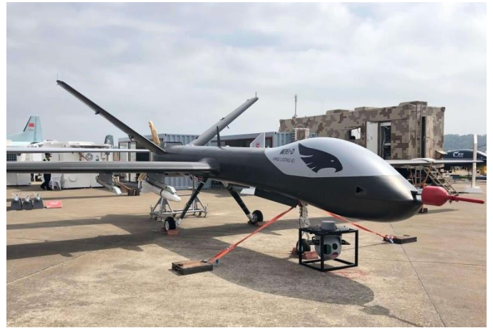
图 30: 全复合材料机身的翼龙 1D
