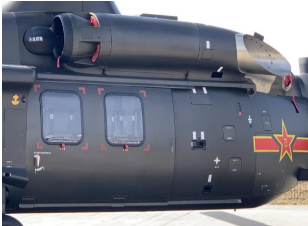
图 29: 直-20 机身大面积使用复合材料
