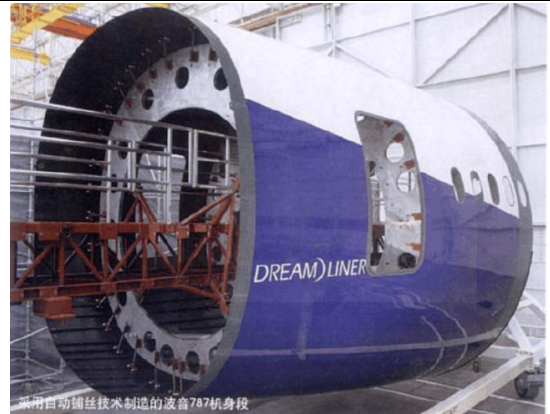
图 13：采用自动铺丝技术制造的波音 787 机身段
