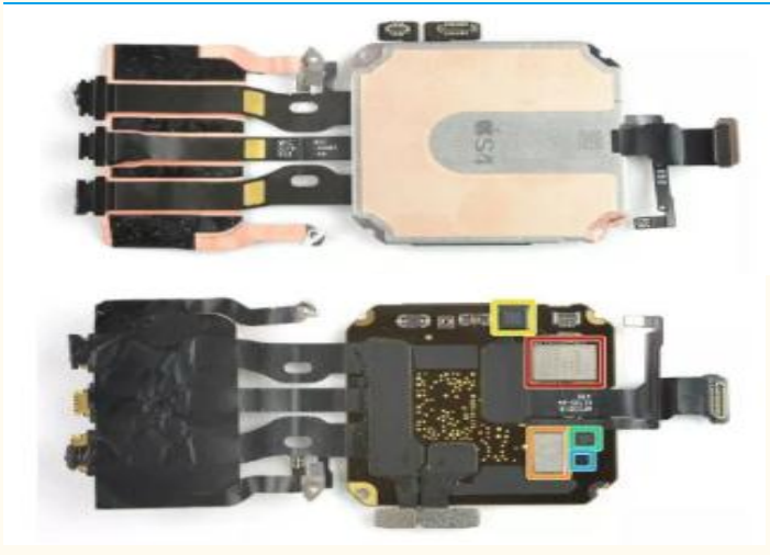
图表 5: Apple Watch 的 SiP 芯片连接示意图
