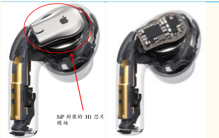
图表 8: H1 芯片 SiP 封装示意图
