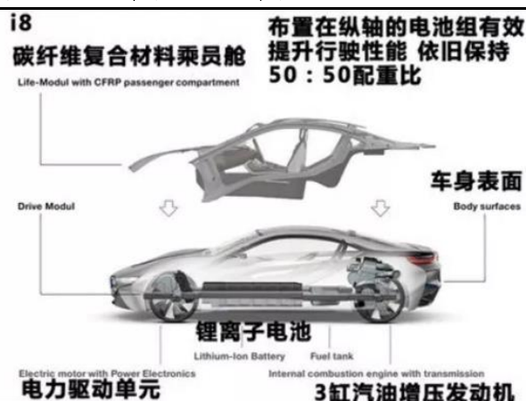
图表 38. 碳纤维复合材料乘员舱
