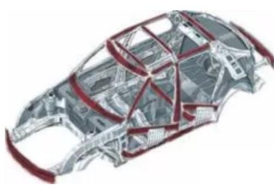
图表 46. 三维辊压技术可能生产的变截面零件
