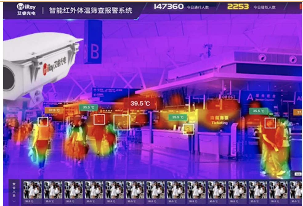
图 355：红外成像仪用于人群密集区域的温度热点的快速捕捉
