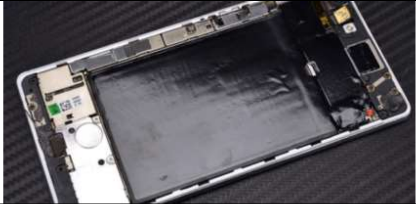
图 13: 石墨片散热方案示意图
