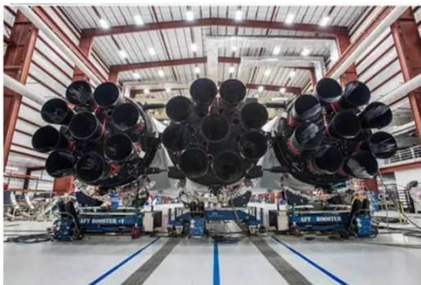
图 9：猎鹰 9 重型火箭共计搭载 27 台发动机
