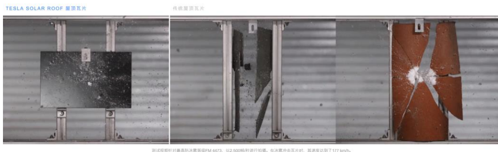
图14: 冰雹测试下 Solar Roof 强度高于普通屋顶材料
