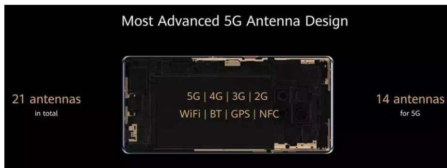
图表 18: 华为 Mate 30 5G 手机的天线设计
