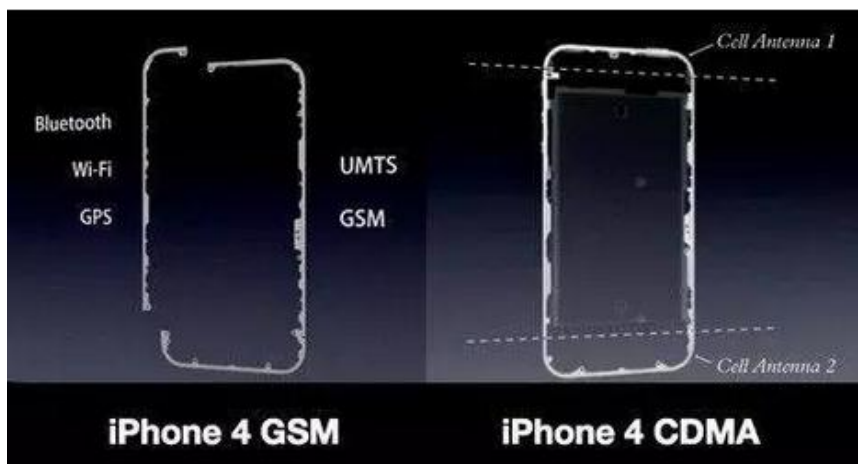
图表 14: iPhone 4 使用金属中框作为天线
