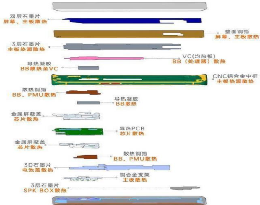
图 16: “导热界面材料+石墨片+VC/热管”立体散热方案有望成为 5G 手机主流
