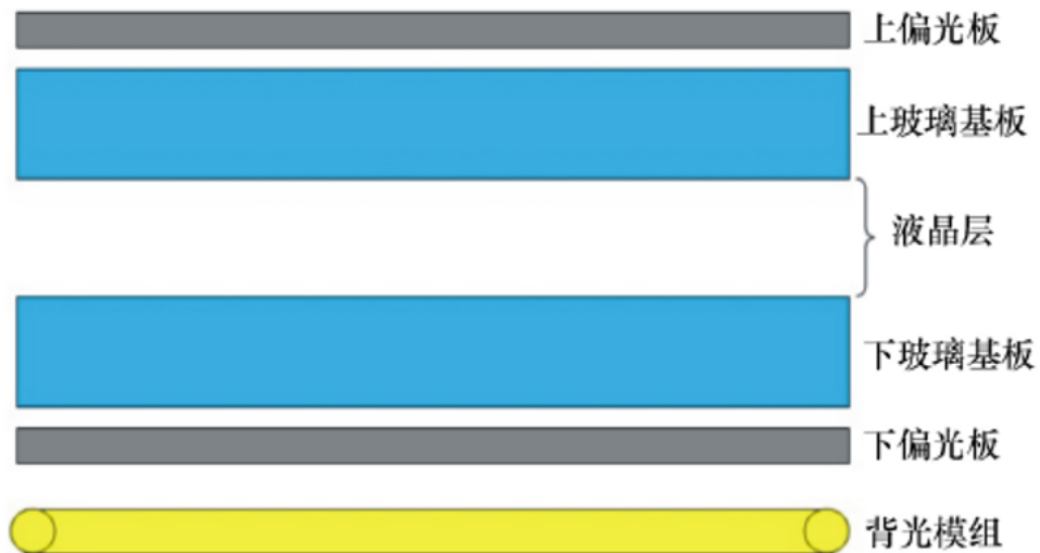
图 3： TFT-LCD 的基本结构
