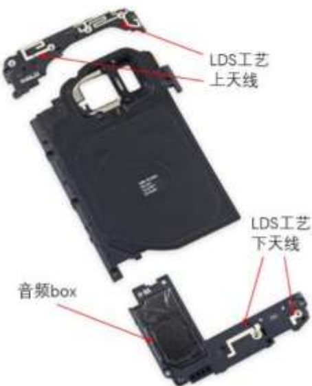
图 52: 三星 S7 采用音射频一体化方案
