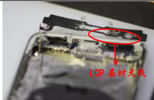
图 33: iPhone X 用 LCP 基材柔性线路板/天线
