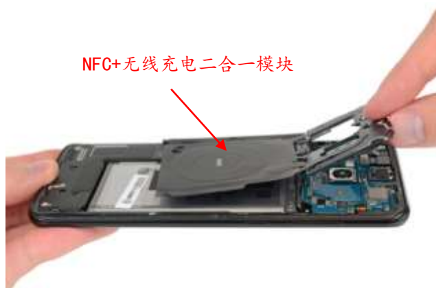
图 24: 三星 S8+采用 NFC+无线充电一体化解决方案
