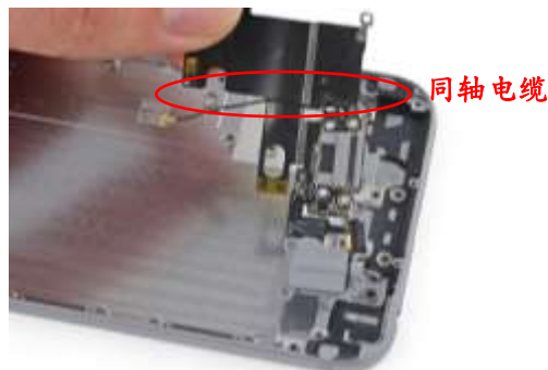
图 35: iPhone 6 用同轴连接器连接主板和天线
