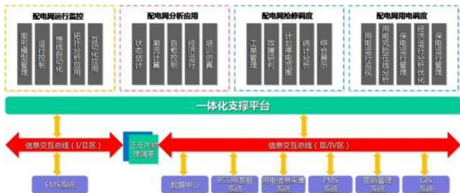
图表42：公司配电网一体化支撑平台
