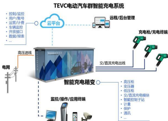
图11: 特来电群管群控系统示意图
