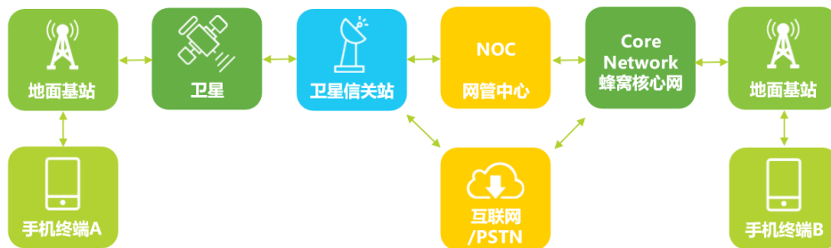
图表41: 一种卫星通信基站回传的网络架构
