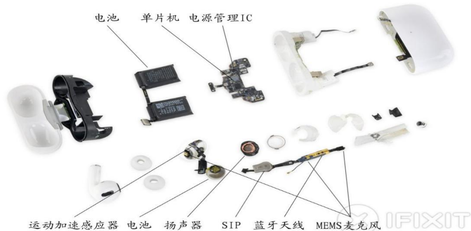
图表11：AirPods Pro 耳机主体和充电盒拆解
