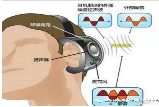
图表7：ANC 主动降噪技术原理
