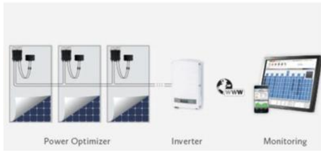
图39: 直流优化逆变系统结构
