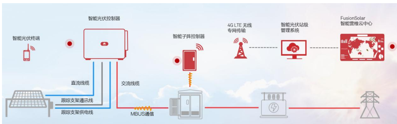
图52： 华为光伏逆变器工作原理示意图
