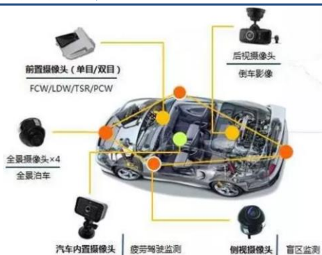
图 35、车载摄像头安装位置
