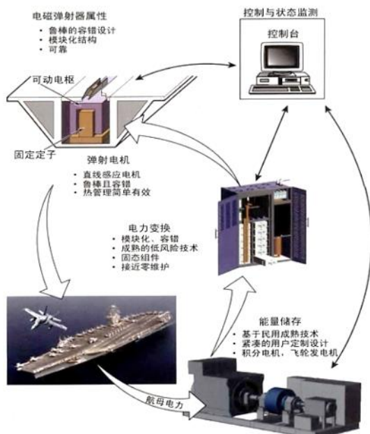
图 8：美国通用原子公司电磁弹射器构成
