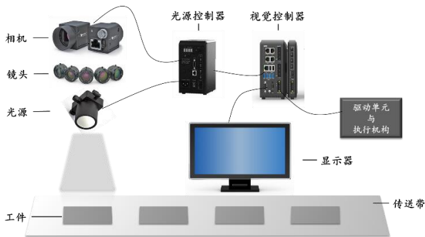
图 4：机器视觉系统的典型构架
