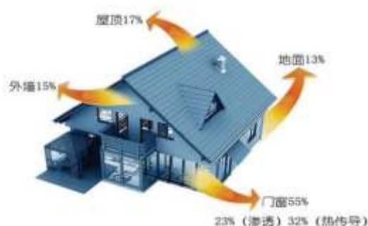
图 45: 建筑不同部位能耗损失
