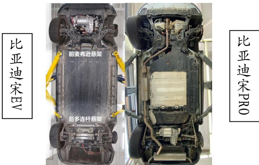
图表：新能源汽车较传统燃油底盘布局增减部件列示
