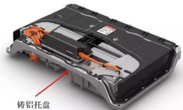
铸铝托盘<br>Audi A3 Sportback e-tron | 支撑、抗机械冲击、机械振动和环境保护（防水防尘）的作用 |
