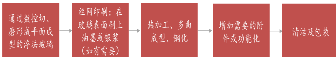
图26：钢化汽车玻璃生产流程
