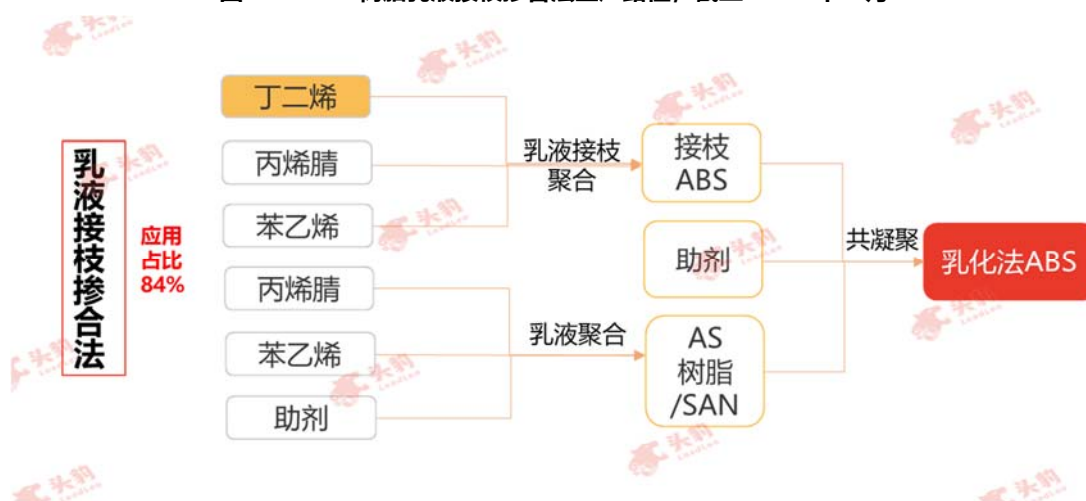
图 2-3 ABS 树脂乳液接枝掺合法生产路径，截至 2019 年 9 月
