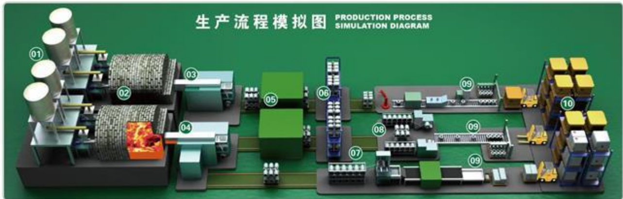
图23：玻纤生产过程示意图
