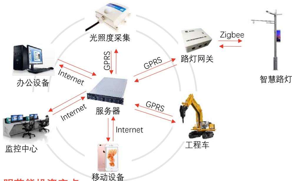
大明节能数字化管理系统包含电子信息、无线通讯、地理信息、图像处理、物联网与云数据等多项现阶段电子技术领域领先的技术，并采用C/S、B/S模式进行混合构架，实现高效的路灯管理系统。
