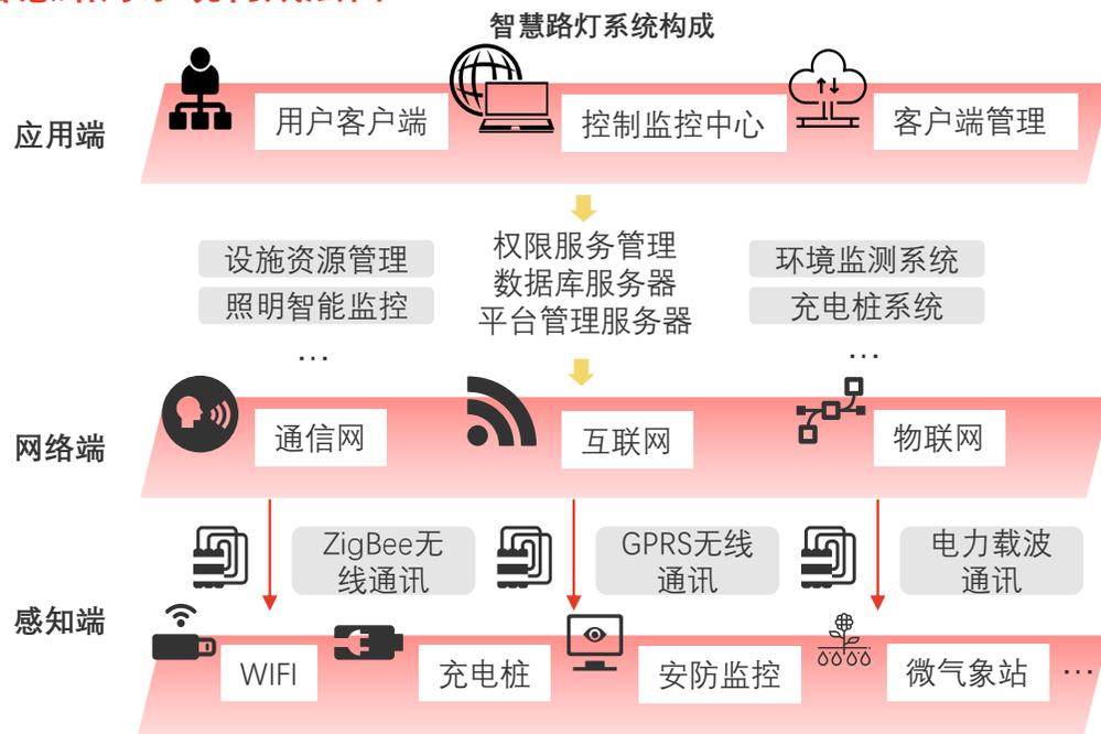
智慧路灯系统主要涉及应用端、网络端、感知端三个层面，各个层面相互配合运作：
