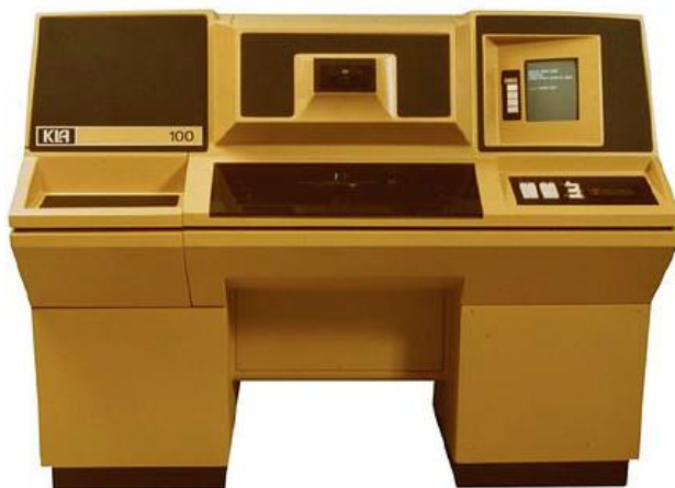
图 KLA第一款产品RAPID 100，自动检测光罩。利用光学和图像处理技术测试印刷电路设计的“模板”
