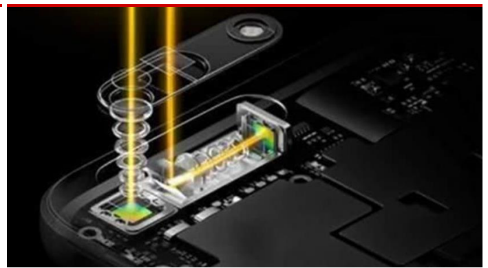
图 31 OPPO 潜望式摄像头结构
