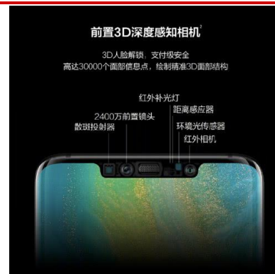
图 62 华为 Mate20 Pro 前置 3D 结构光方案
