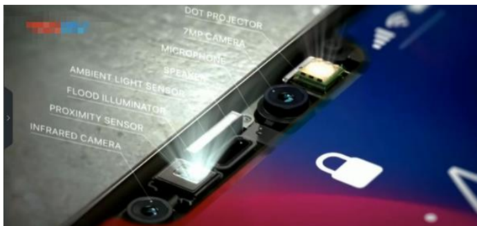
图 61 iPhone X 前置 3D 结构光摄像模组
