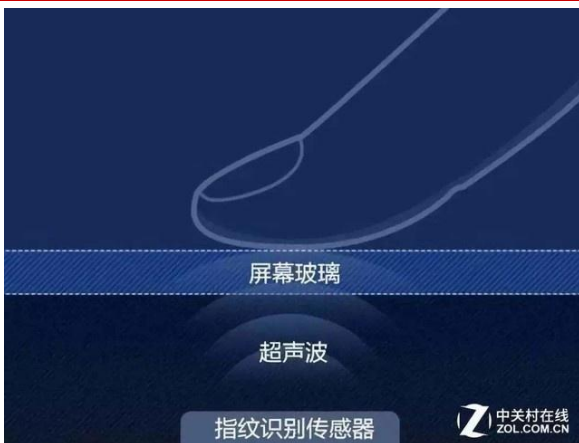
图 51 屏下超声波指纹识别技术
