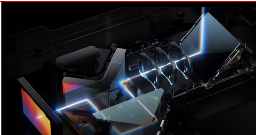
图 32 华为 P40 Pro+潜望式摄像头结构
