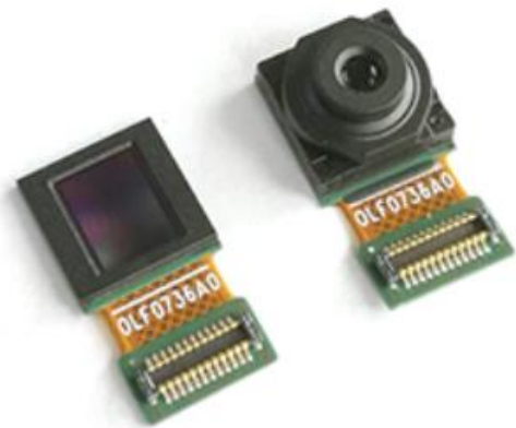
图 19 欧菲光 CMP 封装技术产品
