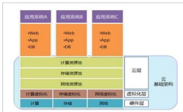
图42：云计算部署架构
