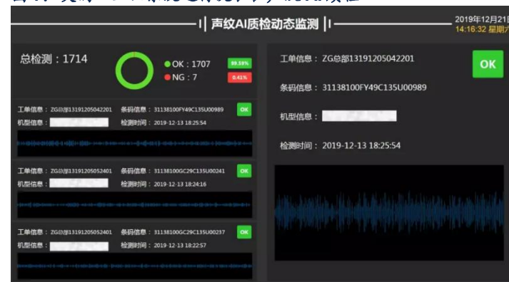
图 7：美的工业云系统进行洗衣机声纹 AI 质检
