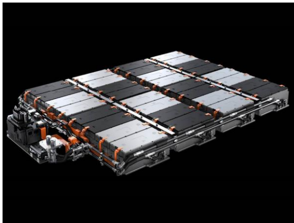
图：蔚来ESS储能系统
