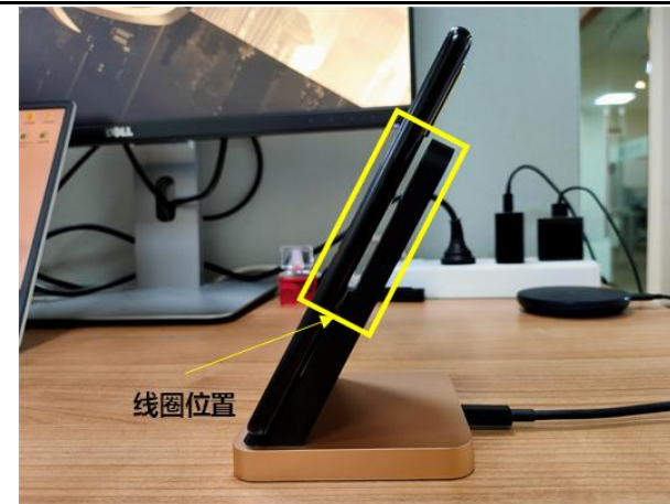
图 42: 立式无线充电器线圈位置
