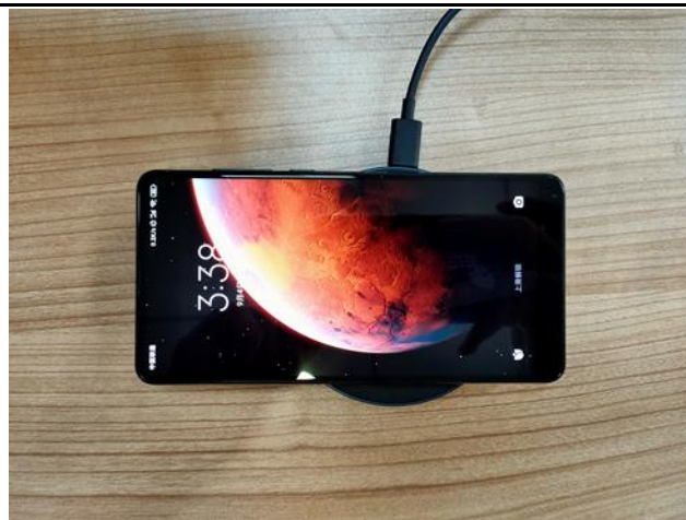
图 39: 手机与无线充电板未对准不能充电
