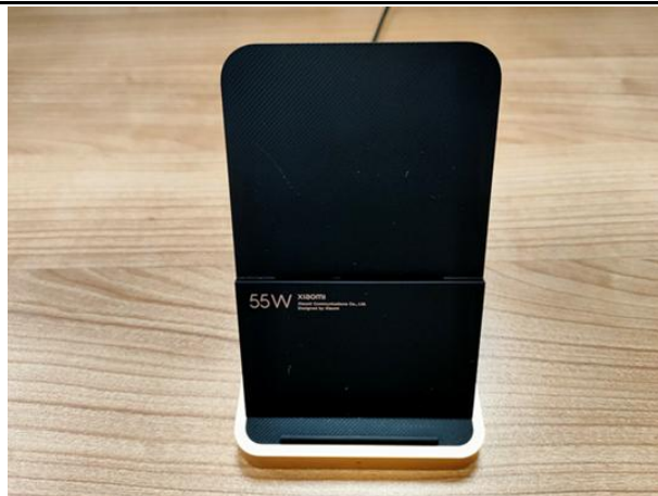
图 41: 立式无线充电器线圈对准相对简易
