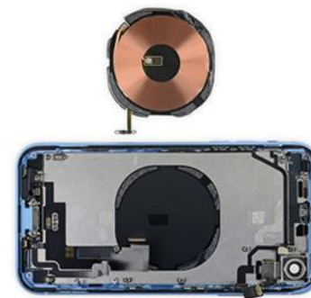
图 24: iPhoneXR 无线充电接收端
