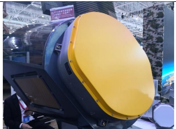
图 16 某所的机载 KLJ-7A 雷达
