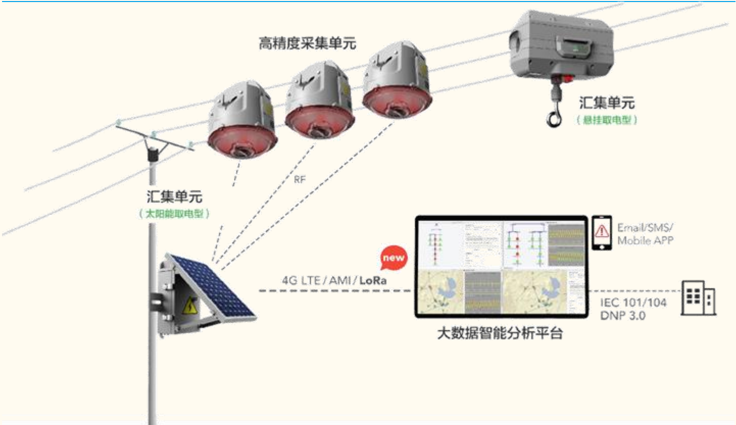
图表 12: 智能配电网线路状态监测系统 (IWOS) 构成
