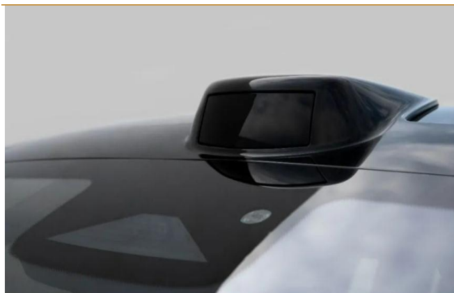
图 2: 理想 L9 在车顶搭载一颗禾赛 AT128 线激光雷达
