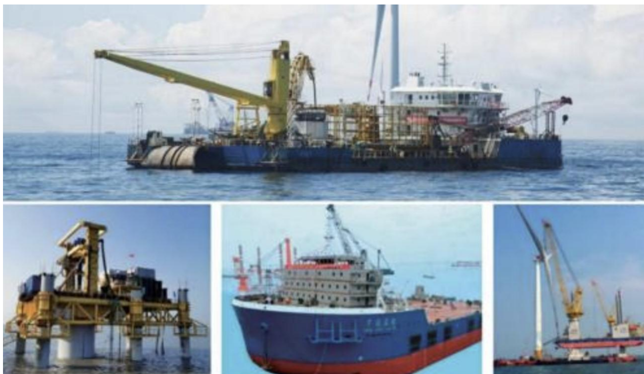
图 19：亨通光电部分海上施工船（敷缆、嵌岩、吊装等）
