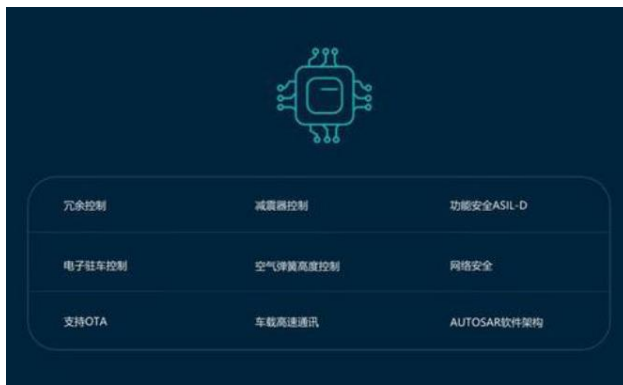
图 41：蔚来 ICC 底盘域控制器集成多个功能
