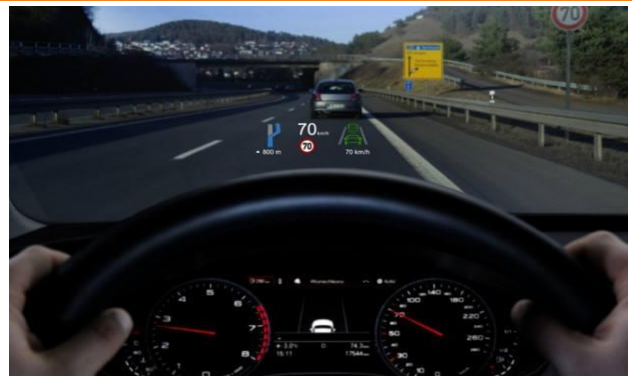
图 2：W-HUD 通过挡风玻璃显示信息，效果更加一体化
