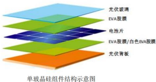
图 12：单玻晶硅组件结构示意图
